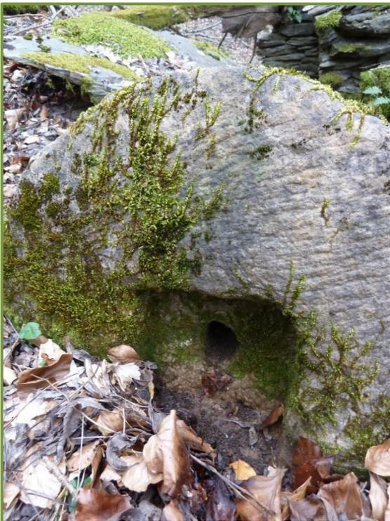
Vue de face, la meule est percée de manière à ce qu'un axe la traverse et qu'elle profite du mouvement de la roue.
